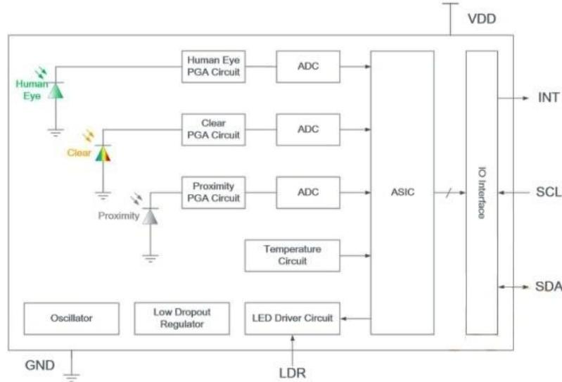
Fig. 1 Block Diagram
